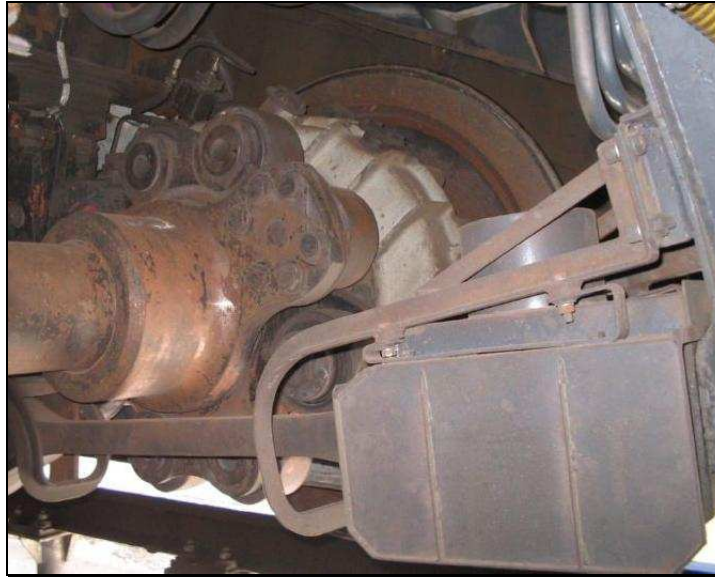
Qui a sopra un'immagine particolare dell'anello danzante e dell'asta di trazione ripreso dal sottocassa.
